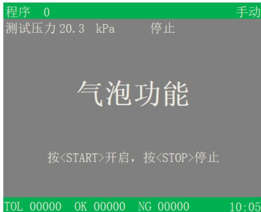
调节精密减压阀，屏幕上的测试压力显示当前的测试压力，调节完测试压力按“
